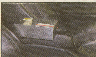
PÅ Plass: Ozonapparatet plassert mellom forsetene. Ozon dreper bakterier som er grunnlaget for den vonde lukten.
